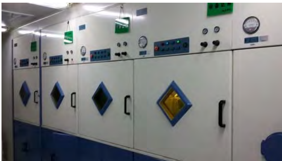
图 9-10 回旋加速器合成热室外观示意图
