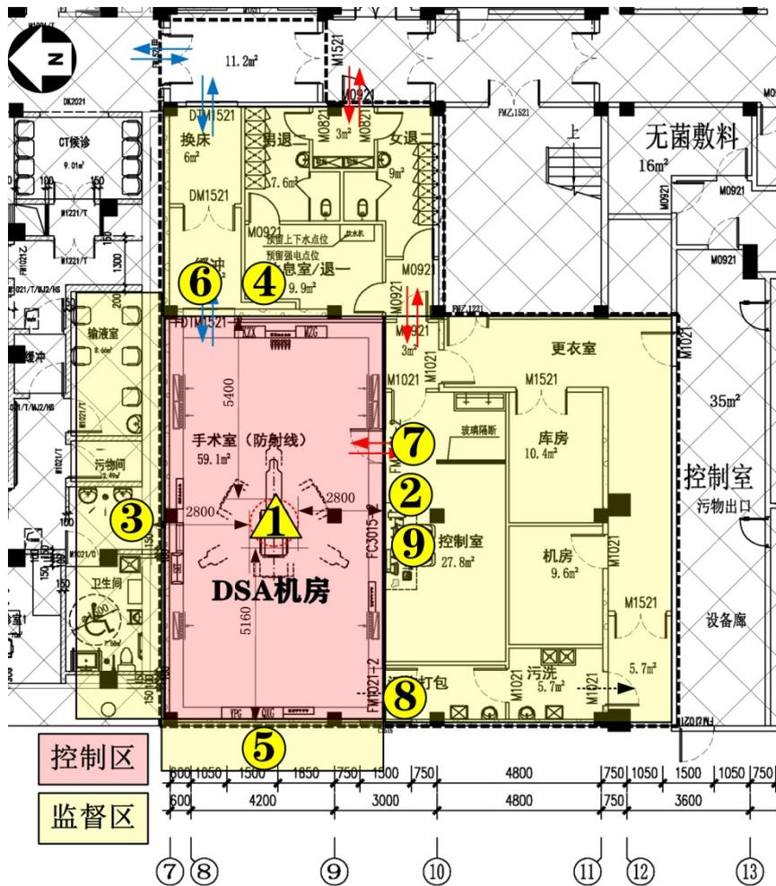
图 11-4 机房周围剂量估算点位置示意图
