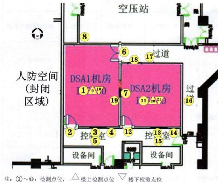
图1 DSA 机房检测点位示意图
